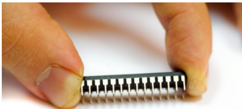
Der Prozessor sollte vorsichtig in den Sockel gelegt werden, so dass alle Pins in den vorgesehenen Kontakten liegen. Erst dann wird der Prozessor vorsichtig und gleichmäßig in den Sockel gedrückt. Da der Prozessor relativ lang ist, können die Pins leicht verkanten und umbiegen.
