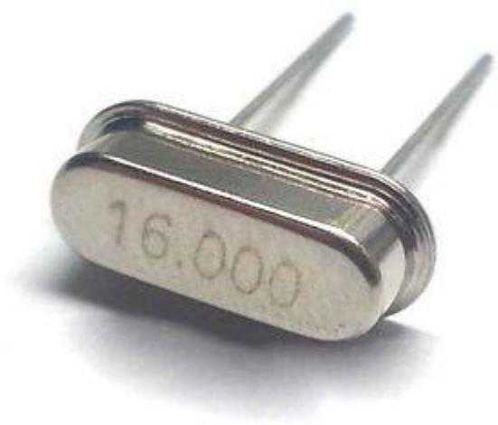
Der 16MHz<sup>2)</sup>-Quarz wird an die Stelle Q1 auf die Vorderseite der Platine eingelötet.
