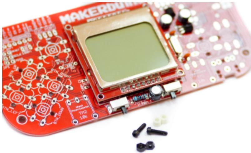
**WICHTIG: BEVOR der Bildschirm eingelötet wird, sollten nochmal alle Lötstellen des Microcontroller-Sockel überprüft werden. Sie sollten alle aussehen wie kleine Vulkane und keine Kaltlötstellen haben. Nachdem der Bildschirm eingelötet wurde, kommt man nicht mehr an diese Lötstellen heran!**
