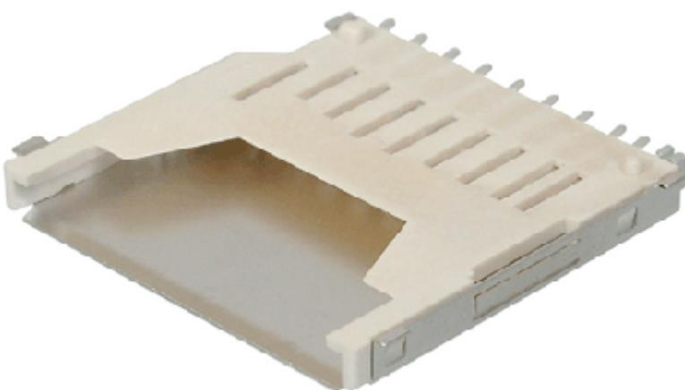
Der Sockel wird auf die Rückseite der Platine an der Stelle `SD card slot1)` gelötet und es soll so aussehen, wenn er eingelötet ist:
