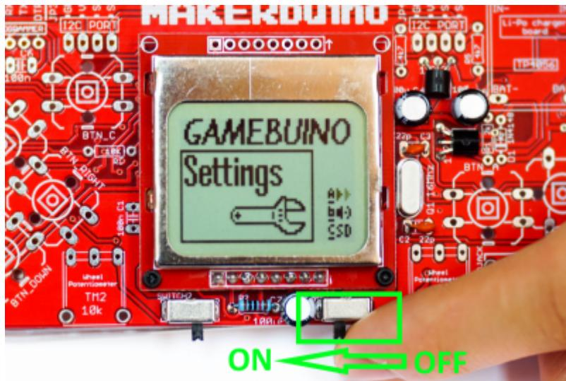
Auch kann eine Anzeige wie `battery low, please turn off` sinngemäß: Batterie ist leer, bitte abschalten erscheinen. Die Ladeplatten für die Batterie wird ebenfalls später verbaut.
