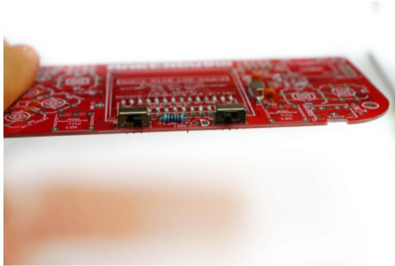
Der linke schaltet den Lautsprecher. Der rechte schaltet die Konsole ein bzw. aus.
