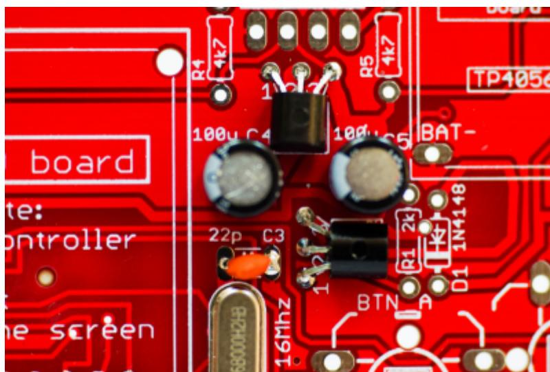
**WICHTIG: Die Richtung ist wichtig. Die flache Seite soll in Richtung Platine gebogen werden, so dass die Komponenten im eingezeichneten Viereck liegen. Dies wird durch vorsichtiges Umbiegen der Komponenten erreicht.**
