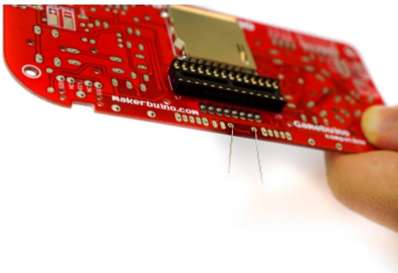
**WICHTIG:** Nach dem Einlöten werden die Beinchen mit dem Seitenschneider gekürzt. Dies wird im übrigen bei allen Pins getan. Ansonsten kann es zu Kurzschläüssen kommen.
