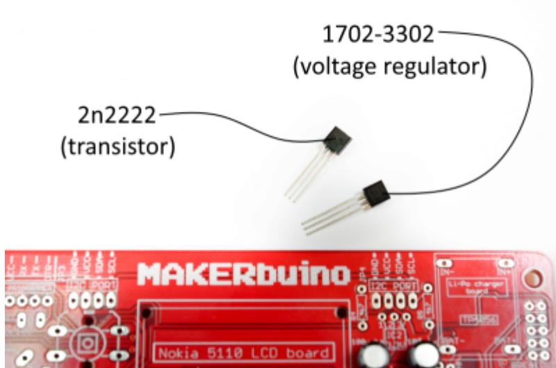
Beide Komponenten werden auf die Vorderseite der Platine gelötet. Der Spannungsregler gehört an die Position IC2 3.3V und der Transistor an die Position T1 2N2222.
