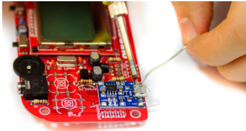
Ebenso muss die Platine auf der Rückseite verlötet werden.
