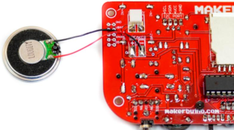
**WICHTIG:** Wenn Drähte auf eine Platine gelötet werden sollen, dann sollte man zunächst etwas Lötzinn auf die Lötstellen der Platine aufbringen und anschließend die Drähte darin fixieren.
