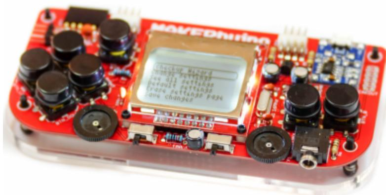
Nun wird die Vorderseite mit dem M3-Abstandshaltern und Muttern befestigt. Wenn eine Handschlaufe im Packet ist, dann kann diese an rechten unteren Abstandshalter befestigt werden.
