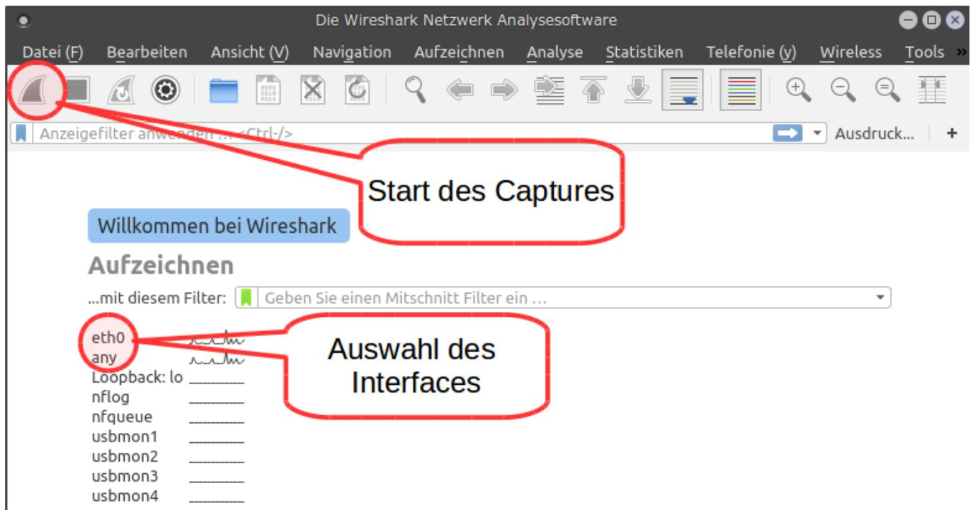
Rechts neben dem Button für die Schnittstellen befindet sich der Button für die Einstellungen des Caputures<sup>1)</sup> selbst.
