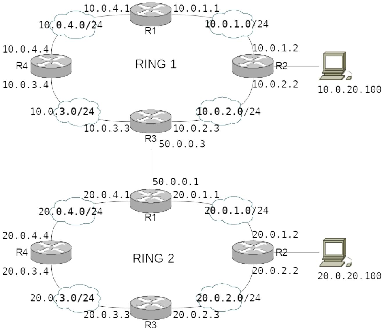
Auf Router 3 des Backbones (RING 1) werden die Routen für 10.0.0.0/16 aggregiert, statt fünf einzelner /24er Netze. Das selbe wird für das 20.0.0.0/16 (RING 2) durchgeführt.
