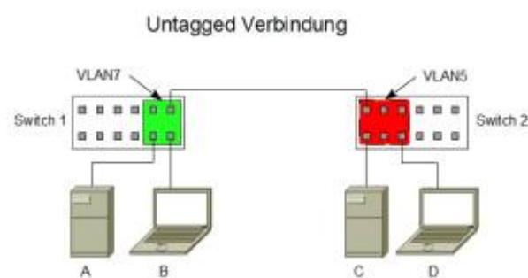
Ein untagged Port kann GENAU EINEM VLAN zugeordnet werden. Die Zuordnung findet implizit über ein bestimmtes Merkmal (MAC, IP, Anwendung usw.) statt. Ports mit dem gleichen Tagging (z.B. VLAN-ID=100) können transparent miteinander kommunizieren.
