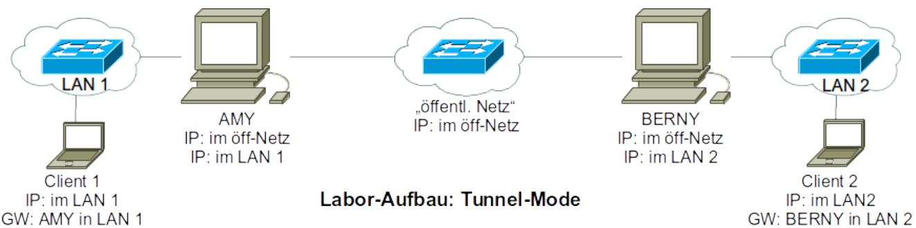
Die Verbindung soll als Tunnel mit automatischer Schlüsselaushandlung (IKE/ISAKMP) aufgebaut werden. Als VPN-Gateway wird der MikroTik-Server eingesetzt, indem dieser auf zwei PCs jeweils als virtuelle Maschine angelegt wird. Als Clients werden zwei normale PCs verwendet.
