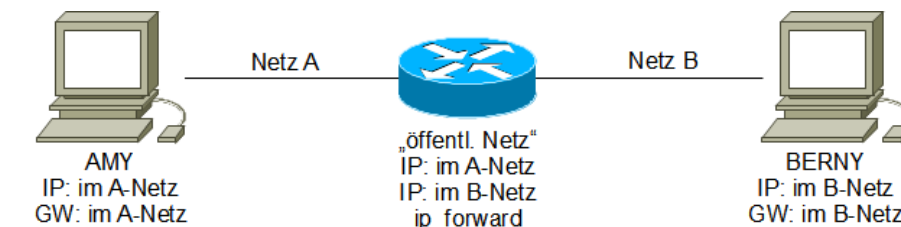
Abbildung 1: VPN: End-to-End im Transport-Modus (manuell konfiguriert)
