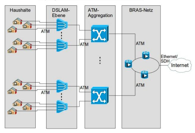
Mittelfristig wird diese Struktur aufgrund der fehlenden Multicast-Eigenschaft gegen Ethernet (s. VDSL) ersetzt. Das Multicast-Feature, also die Möglichkeit Datenströme bis hin zum DSL-AM einmalig (unicast) und von dort auf die einzelnen Teilnehmer aufzuteilen (multicast) wird insbesondere für die Verteilung von Fernsehprogrammen im IPTV Umfeld benötigt.
