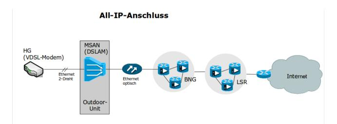
HG: vergleichbar IAD (DSL-Modem, Router, Switch, WLAN-AP,...)
