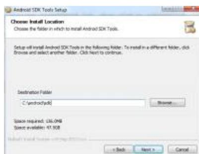
ACHTUNG: Der Installer fragt am Ende nach, ob der SDK-Manager gestartet werden soll. Da wir Eclipse bereits installiert haben, darf der SDK-Manager NICHT direkt im Anschluss gestartet werden. Das wird später erledigt.
