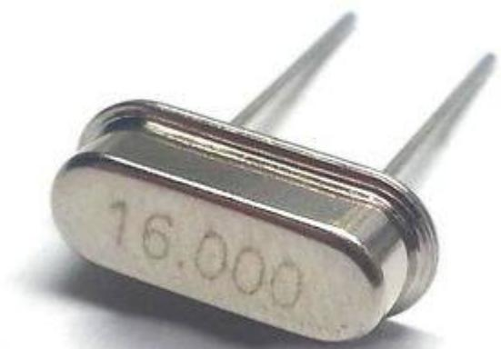
Der 16MHz<sup>2)</sup>-Quarz wird an die Stelle Q1 auf die Vorderseite der Platine eingelötet.
