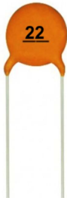
Die beiden Kondensatoren C2 und C3<sup>3)</sup> werden neben den Quarz Q1 eingelötet. Die Ausrichtung dieser Kondensatoren ist egal. Bei den Elektrolytkondensatoren ist das nicht egal vgl. Schritt 7.
