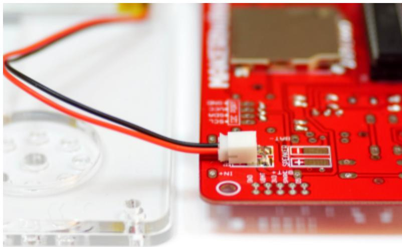
Anschließend wird mit dem Ein-/Ausschalter der MAKERbuino gestartet. Wenn alles korrekt funktioniert, dann sollte jetzt eine Textnachricht auf dem Bildschirm erscheinen. Falls der Bildschirm zu dunkel ist, ist das normal. Die Regelung für den Bildschirm wird später eingebaut.
