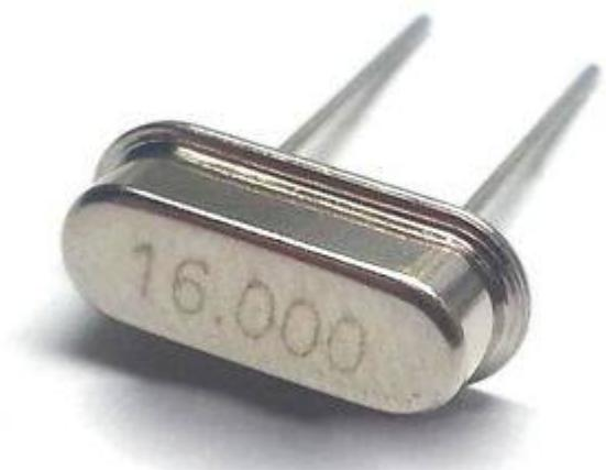
Der 16MHz<sup>2)</sup>-Quarz wird an die Stelle Q1 auf die Vorderseite der Platine eingelötet.
