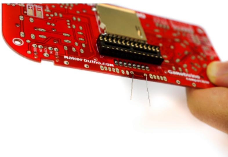
**WICHTIG:** Nach dem Einlöten werden die Beinchen mit dem Seitenschneider gekürzt. Dies wird im übrigen bei allen Pins getan. Ansonsten kann es zu Kurzschläüssen kommen.
