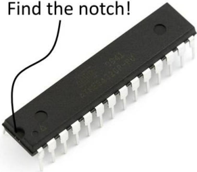
Bevor es ans Einsetzen geht, müssen die Pins geprüft werden. Sie sollen alle gerade in einer Linie sein. Falls nötig kann dies durch vorsichtiges Biegen korrigiert werden.
