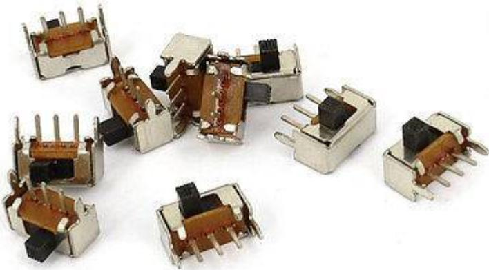
Die Schiebeschalter werden auf die Frontseite an den Positionen SWITCH1 und SWITCH2 eingelötet. Dabei sollen die Schalter gut auf der Platine aufsitzen, damit sie beim Schalten nicht abbrechen.
