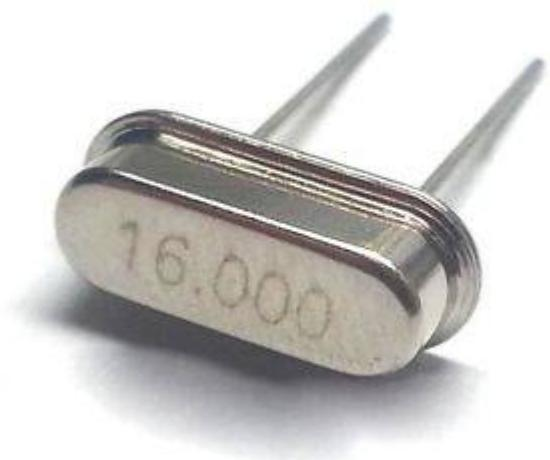
Der 16MHz<sup>2)</sup>-Quarz wird an die Stelle Q1 auf die Vorderseite der Platine eingelötet.
