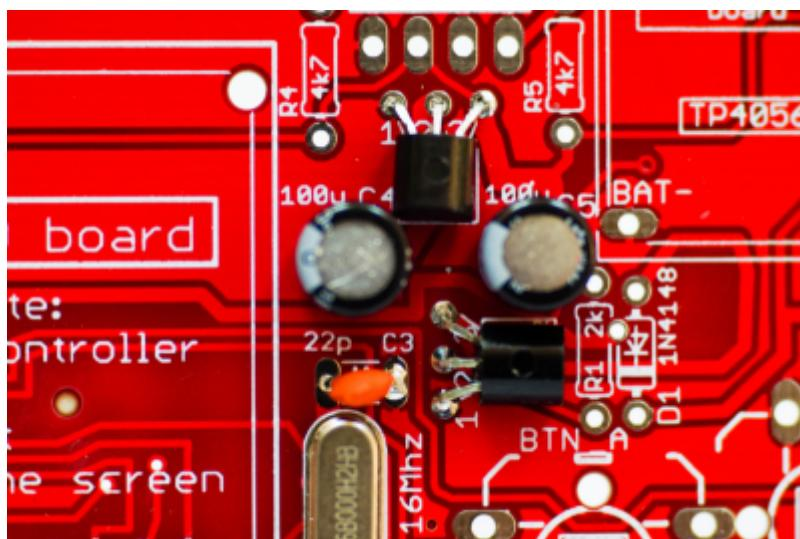
**WICHTIG: Die Richtung ist wichtig. Die flache Seite soll in Richtung Platine gebogen werden, so dass die Komponenten im eingezeichneten Viereck liegt. Die wird durch vorsichtiges Umbiegen der Komponenten erreicht.**
