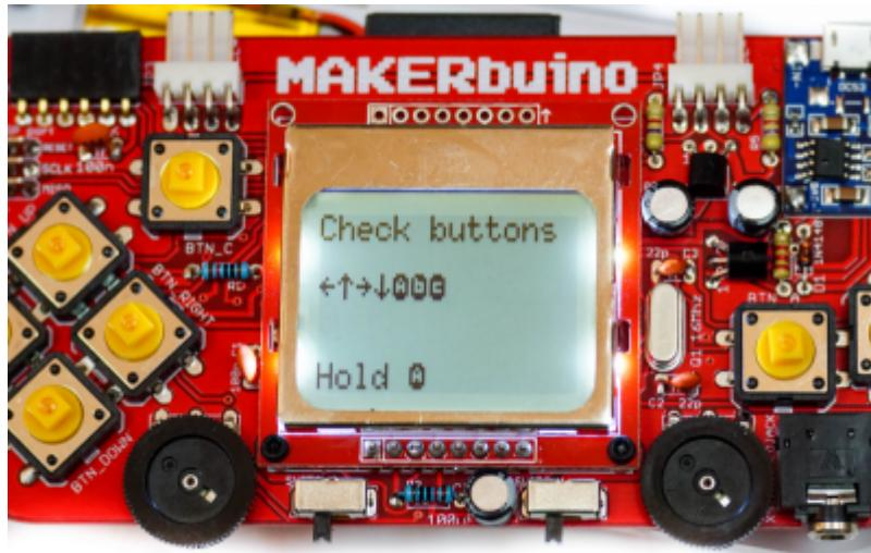
Im Anschluss wird die Lautstärke mit dem rechten Potentiometer TM1 eingestellt. Wenn alles wie beschrieben funktioniert, können die Einstellungen gespeichert werden und der MAKERbuino ausgeschaltet werden. Nun wird die SDCard in den Sockel gesteckt und der MAKERbuino wieder eingeschaltet.
