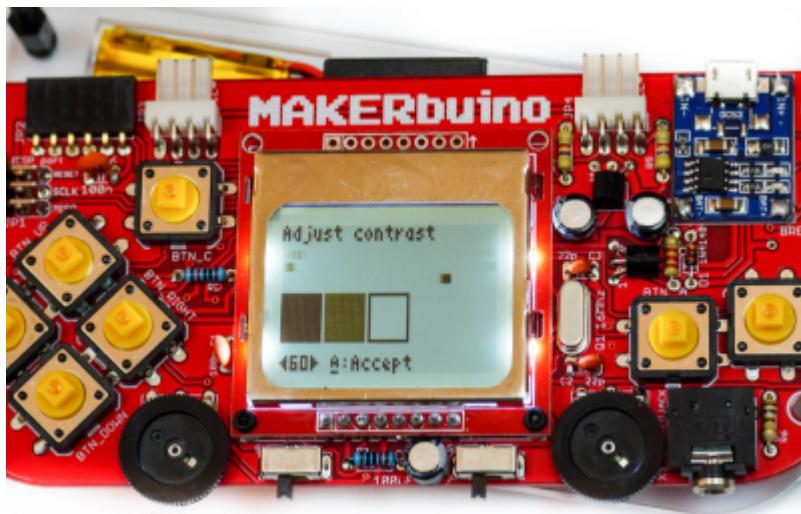
Nun kann man den [checkup wizard<sup>5\)</sup>](#) durchlaufen und überprüfen, ob alle Taster funktionieren. Ist dieser durchlaufen, sollte der Ton aktiviert werden. Dieser kann mit dem rechten Potentiometer TM1 eingestellt werden.
