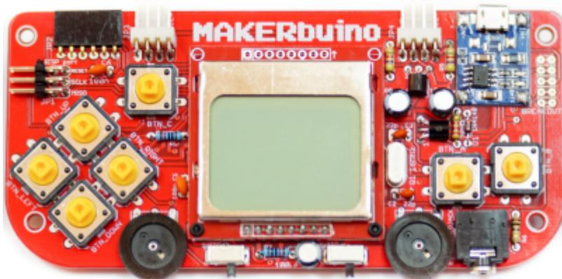
**WICHTIG:** Die Pins der Taster müssen ganz in die Platine geschoben werden, damit sie später bei Betätigen der Taster nicht umgebogen werden und abbrechen.
