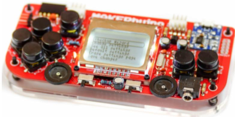
Nun wird die Vorderseite mit dem M3-Abstandshaltern und Muttern befestigt. Wenn eine Handschlaufe im Packet ist, dann kann diese an rechten unteren Abstandhalter befestigt werden.
