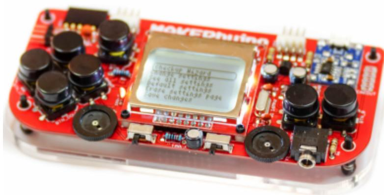
Nun wird die Vorderseite mit dem M3-Abstandshaltern und Muttern befestigt. Wenn eine Handschlaufe im Packet ist, dann kann diese an rechten unteren Abstandshalter befestigt werden.
