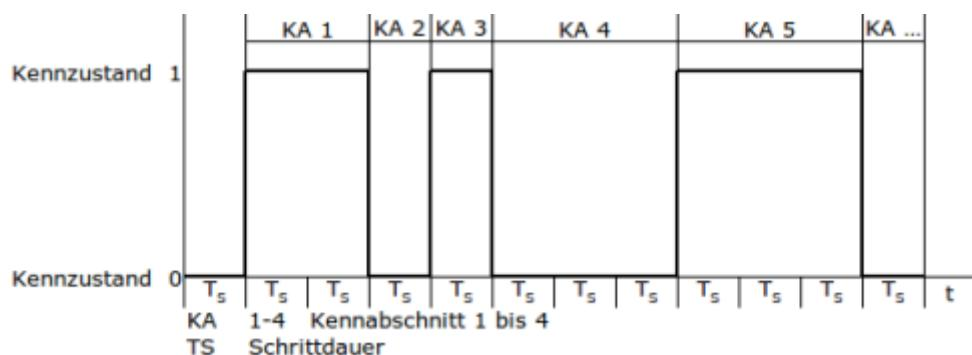
Das digitale Signal kann nach der **Schrittdauer  $T_s$**  seinen **Kennzustand** ändern. Die Zeitspanne, während das Signal sich nicht ändert, ist der **Kennabschnitt  $K_A$** . In diesem Beispiel sind genau zwei Kennzustände zulässig. Ein solches Signal nennt man **binär**<sup>4)</sup>. Die möglichen Informationen 0 und 1 haben die Einheit Bit (**binary digit**).
