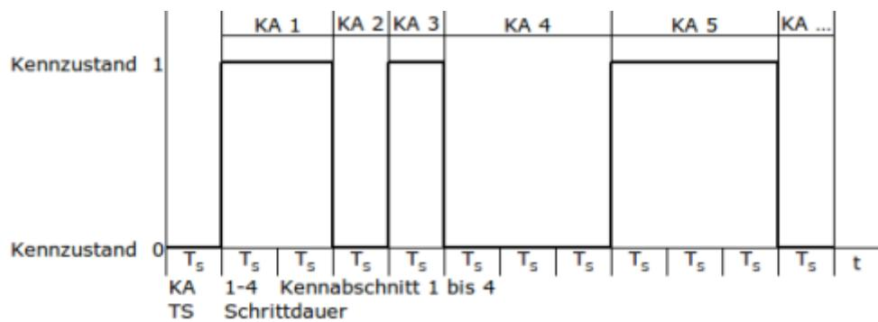
Das digitales Signal kann nach der **Schrittdauer  $T_s$**  seinen **Kennzustand** ändern. Die Zeitspanne, während der das Signal sich nicht ändert, ist der **Kennabschnitt  $K_A$** . In diesem Beispiel sind genau zwei Kennzustände zulässig. Ein solches Signal nennt man **binär<sup>4)</sup>**. Die möglichen Informationen 0 und 1 haben die Einheit Bit (**binary digit**).
