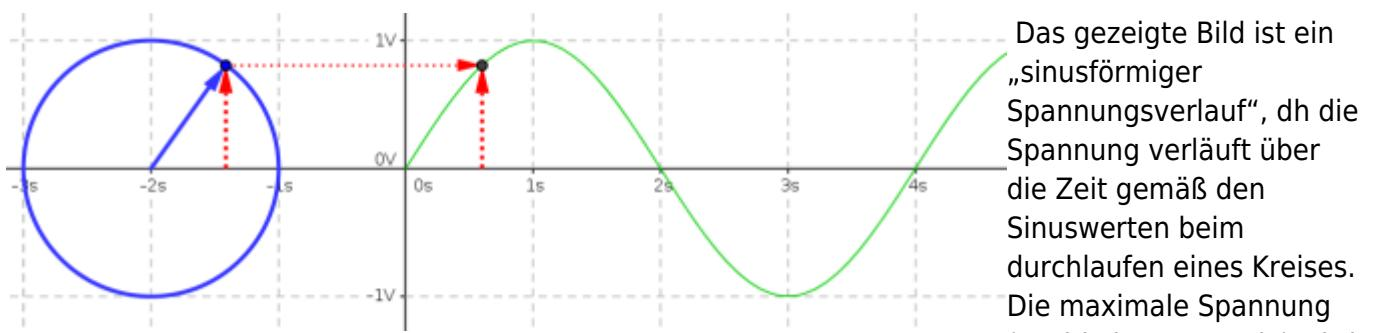
auch **Amplitude A** genannt. Die „Geschwindigkeit“ mit der einmal alle Sinuswerte durchlaufen werden, nennt man **Frequenz f**. Die **Periodendauer T** gibt an, wie viel Zeit für einen vollständigen Umlauf des Kreises benötigt wird. Je schneller der Kreis umlaufen wird, umso höher ist die **Frequenz f** und umso kürzer die Zeit T.
