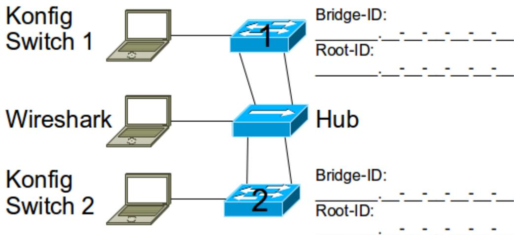
HINWEIS: Sie können alternativ zum PC für die Aufzeichnung mit Wireshark auch eine nicht genutzt Schnittstelle, der beiden Konfigurations-PCs nutzen.
