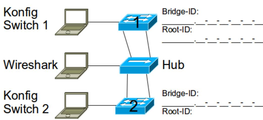
**HINWEIS:** Sie können alternativ zum PC für die Aufzeichnung mit Wireshark auch eine nicht genutzt Schnittstelle, der beiden Konfigurations-PCs nutzen. - Schalten Sie die Switches noch nicht zusammen.
