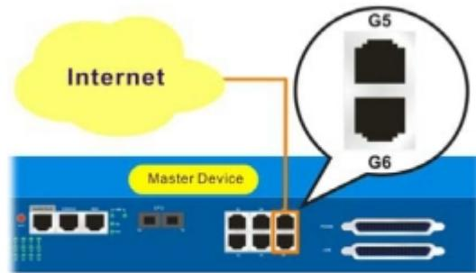
Da wir als Uplink ins Internet (sprich Verbindung zum BRAS) kein LWL<sup>1)</sup> verwenden, muss als Uplink der Port G5 oder G6 benutzt werden. Weiterhin muss per Kommandozeile (telnet) der entsprechende Anschluss als Uplink konfiguriert werden.
